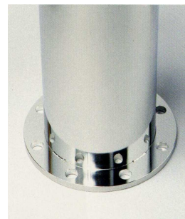
不動態化処理 (パフ→クリーンブライト処理→フェロチェック)
