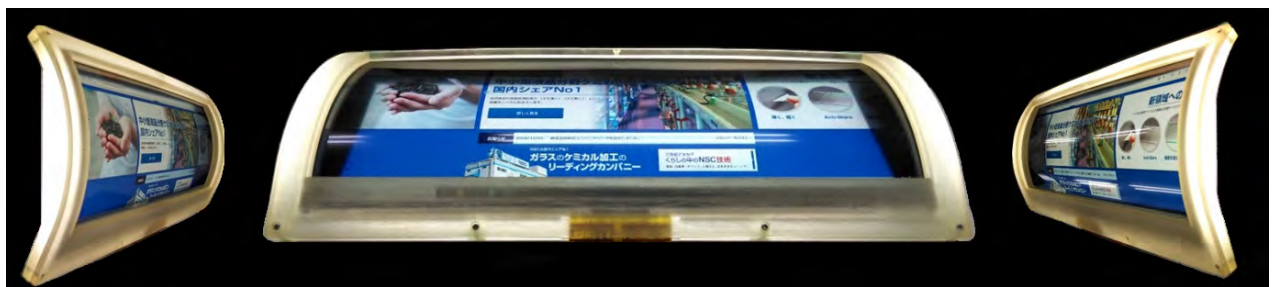
短辺固定曲面の液晶パネル（曲率半径 R100mm）
