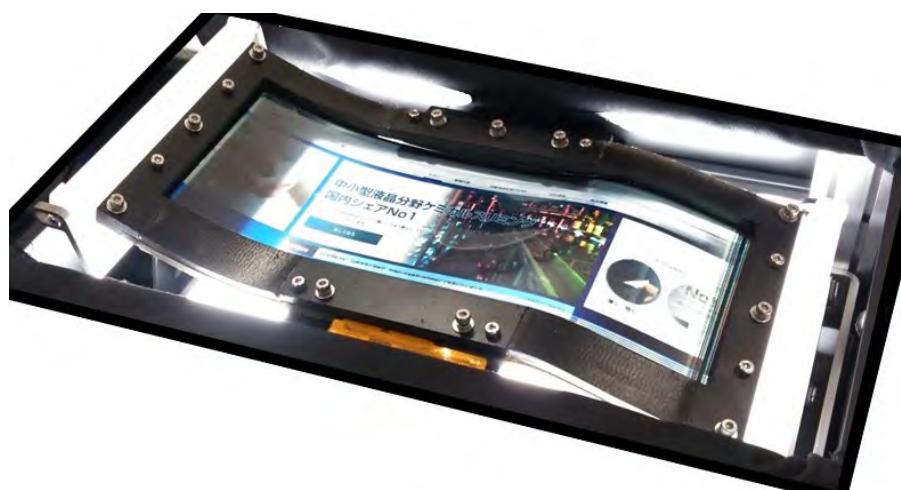
長辺可変曲面の液晶パネル（最小曲率半径 R100mm）
